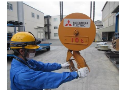
クレーンフック状態点検状況
