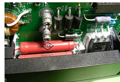
電子機器組立品の高電圧部位へ真空脱泡下での絶縁樹脂注入
